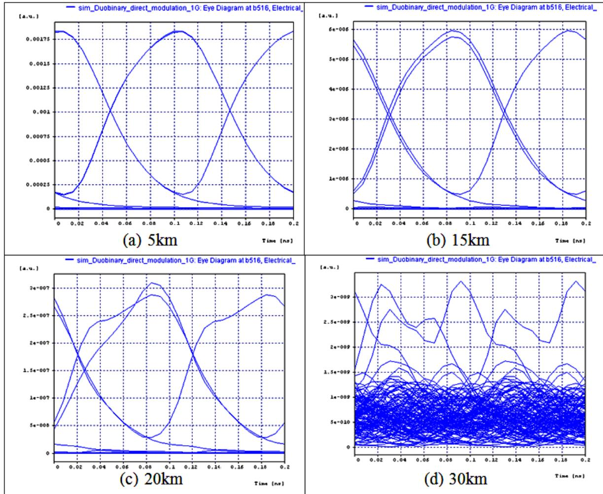
Fig. 6. Eye diagram with 1Gbps bit rate at (a) 5km; (b) 15km; (c) 20km; (d) 30km.
