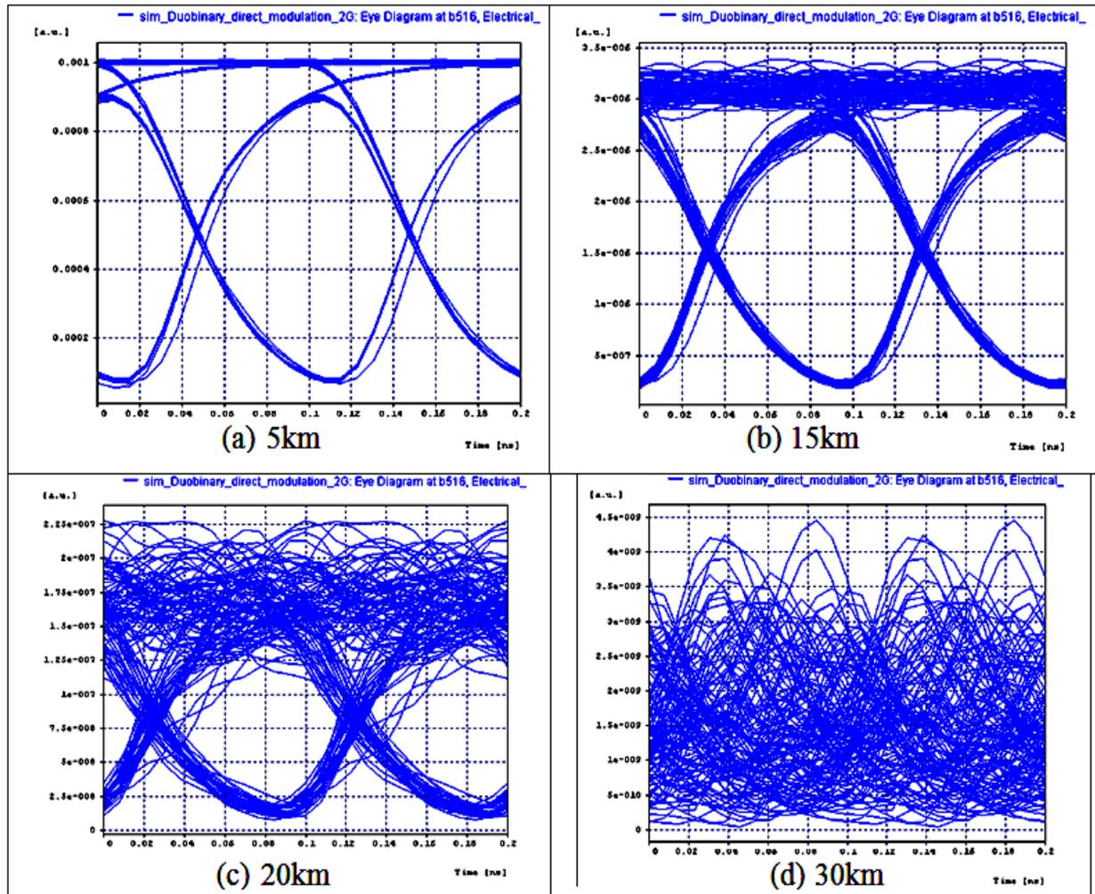
Fig. 7. Eye diagram with 2.5Gbps bit rate at (a) 5km; (b) 15km; (c) 20km; (d) 30km.
